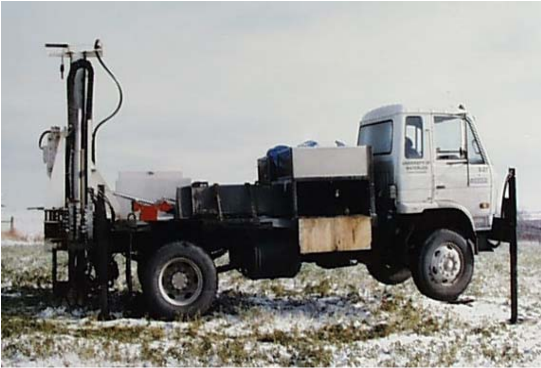
شكل (5.8) صورة لإحدى الحفارات المستخدمة في تجريات التربة
