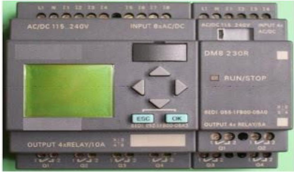
الشكل ( 3 - 1 ) جهاز الـ PLC
